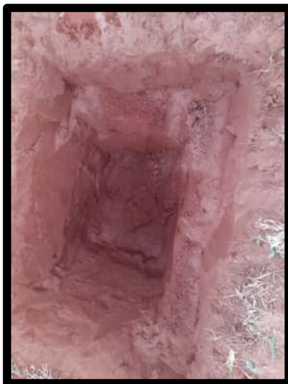
FOTO 3 - Abertura de furo para coleta de amostras
