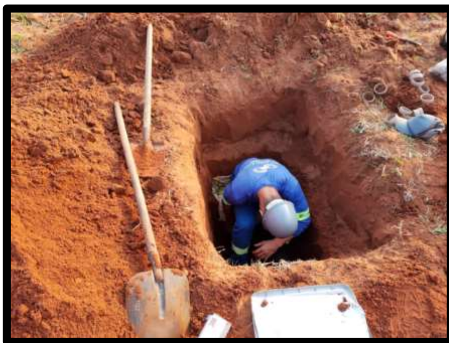
FOTO 4 – Utilização de anéis para coleta de amostra indeformada
