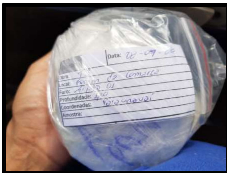
FOTO 6 – Coleta e etiquetagem de amostra indeformada - AI01
